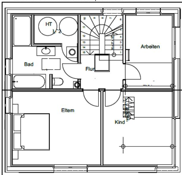
zimmer, ein Arbeitszimmer und das Familienbad. Die Haustechnik liegt im Obergeschoss direkt hinter dem Bad. Dort ist auch der Pufferspeicher, Beheizt wird das Haus durch den zentralen Ofen im Erdgeschoß, sowie einer heizungsunterstützenden Solarthermie-Anlage.
