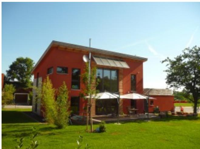
Nach Süden offen für Licht und Ausblick. Das Haus erhält ein Pultdach, hinter der großen Scheibe in der Mitte befindet sich eine Galerie-Ebene. Die Dachterrasse auf der Garage kann vom Bad aus begangen werden. Das Hauptdach ist begrünt.
